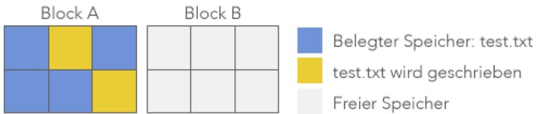
Da nun in einem Block nicht nur ein Cluster liegt, sondern im Standardfall bis zu 8, kann für Fall 2 eine bis zu 8-fache Reduktion der Schreibzyklen bewirkt werden, im Vergleich zu Fall 1. Dies verlängert die Lebensdauer der SSD enorm. Eine solche Reduktion der verwendeten Blöcke kann mit den speziellen Methoden zur Defragmentierung von SSDs durch O&O Defrag erreicht werden.
